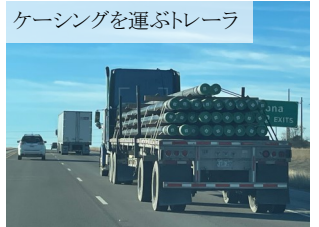
ケーシングを運ぶトレーラー
