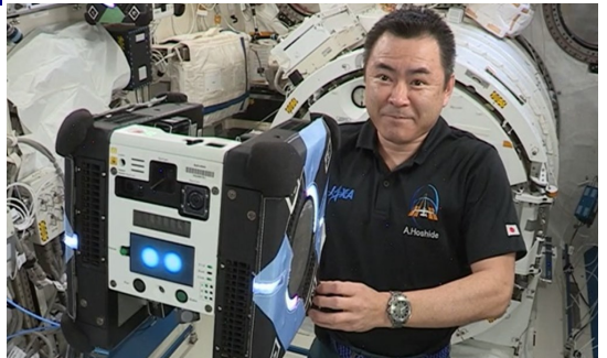
▲星出宇宙飛行士と『Kibo-RPC』で使用されるNASAの自律飛行ロボット「Astrobee」（写真提供：JAXA/NASA）
