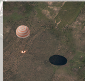
【着陸】2010年6月2日ソユーズTMA-17宇宙船(21S)の着陸。ソユーズは着陸の衝撃を緩和するために着陸直前に逆噴射をします。この写真は逆噴射の瞬間を撮影した大変珍しい写真です。(出典JAXA/NASA/Bill Ingalls)
